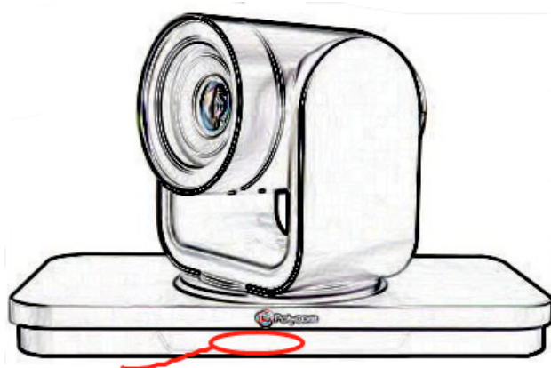
【图 9.3 Polycom 摄像头红外线放置位置】
