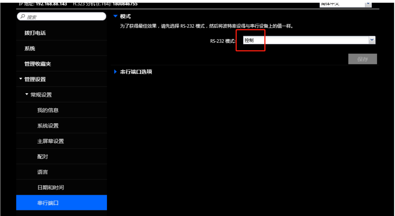
【图 9.10 Polycom WEB 页面设置串口控制按键】
