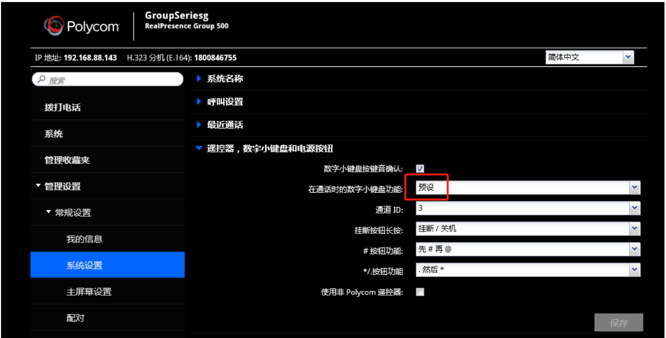
【图 9.9 Polycom WEB 页面设置遥控器数字功能键】
